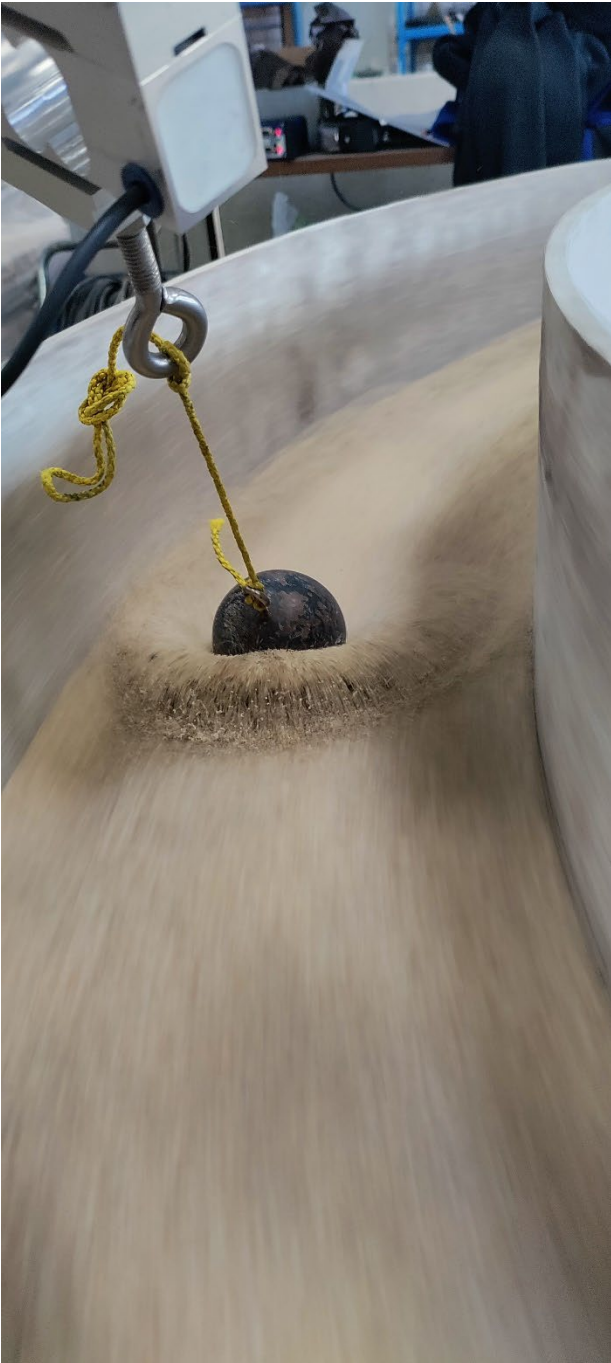
3 Verschiedene abgebaute Böden bewirken unterschiedliche Kräfte und Impulse auf die Messinstrumente. (Foto: STUVA e.V.)
