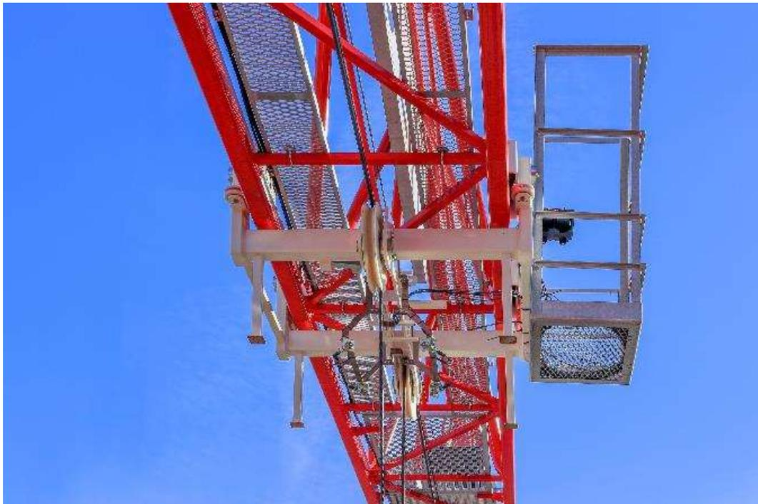
Das High-Speed-Positioning-System legt den Grundstein für den autonom fahrenden, digitalisierten Kran. Die Kranbewegungs- und Positionsdaten, die das HiSPS generiert, können in die moderne digitale Baustellenorganisation mittels Building Information Modelling (BIM) integriert werden.
