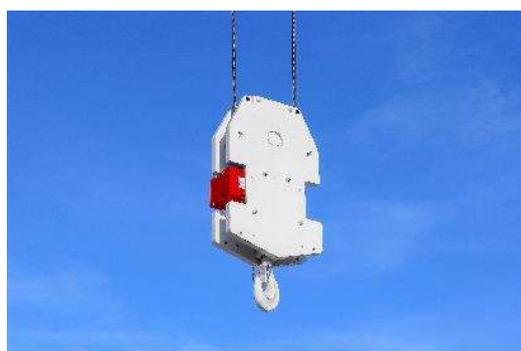
Das zuschaltbare Assistenzsystem HiSPS arbeitet durch akkubetriebene Sensoren an Laufkatze und Unterflasche des Kranhakens. Verbunden mit einer Steuerungseinheit im Schaltschrank erkennen diese die Bewegungen des Seils und passen die Bewegung und Geschwindigkeit von Drehwerk und Laufkatze automatisch daran.
